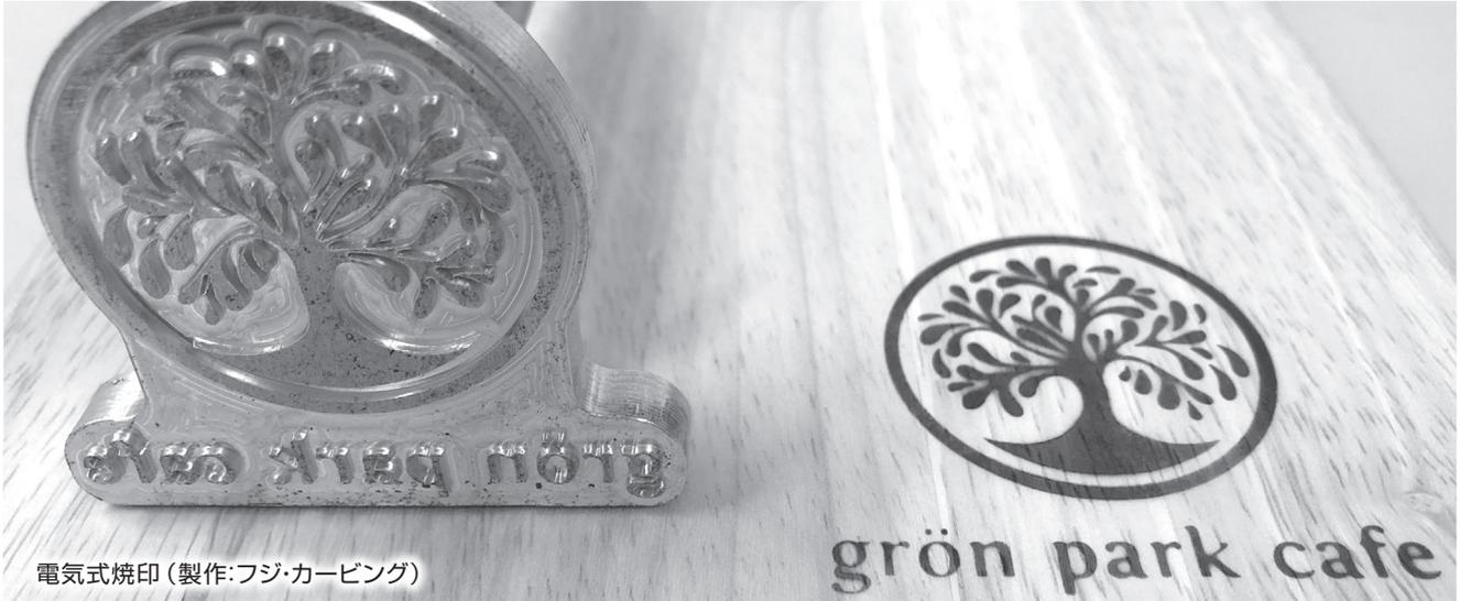
電気式焼印 (製作:フジ・カービング)
